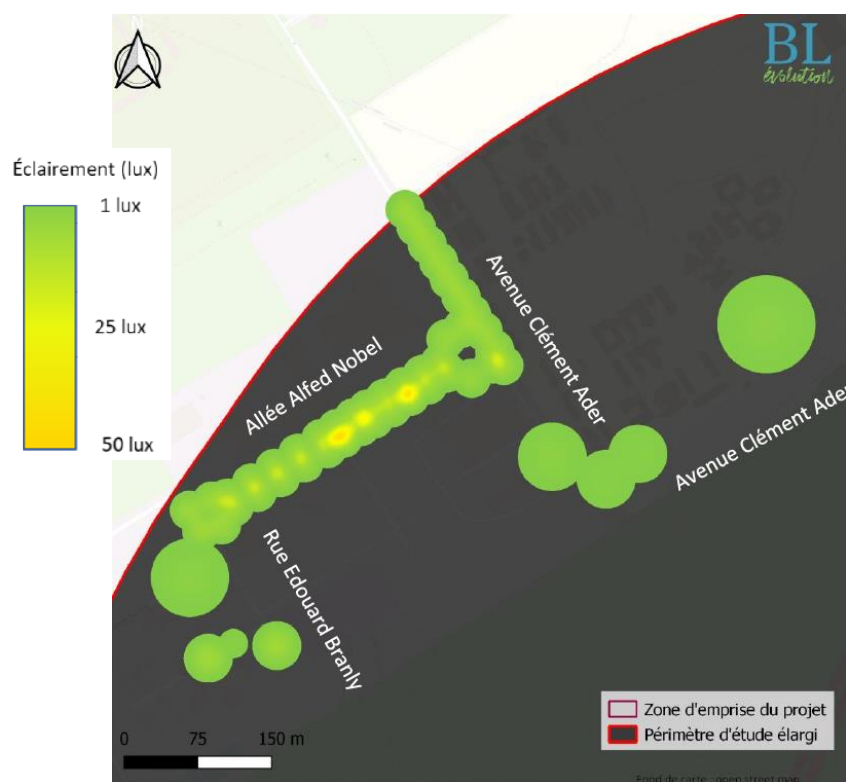
Modélisation de l'éclairage sur la zone nord-ouest – État initial (Source : BL évolution, juin 2021)
